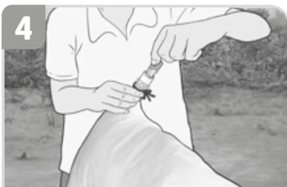
**Insertar un tubo de PVC en el orificio de la esquina inferior de la base.** Asegurar el tubo con un **tapón** para garantizar el sellado y hermeticidad del envase. Reforzar la unión del tubo con la bolsa con jebe.
